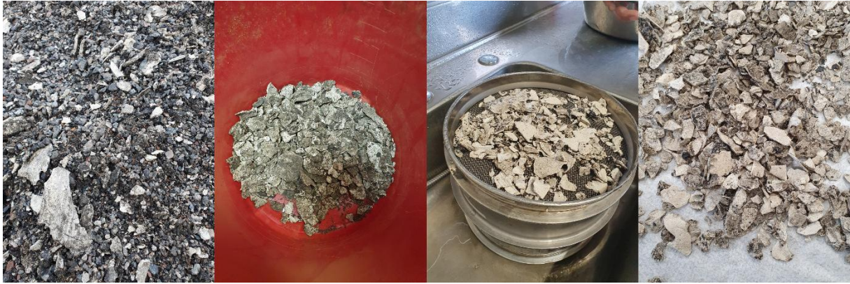
Figur 3 Från vänster till höger: (1) Insamlat material från mekanisk fräsning, bestående av en blandning av termoplastisk vägmarkering, asfalt, grus och vägdamm; (2) material efter en första siktning; (3) material under tvättprocessen; och (4) tvättat och siktat material, redo för att smältas till block.
