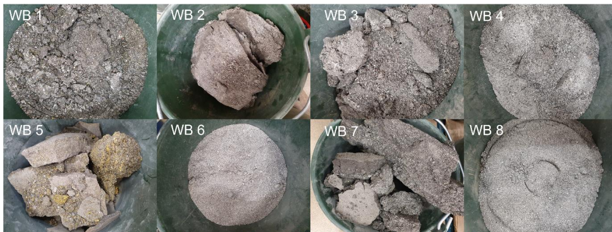
Figur 5 Åtta olika materialprover som samlats in med vattenblästring (WB1-WB8).
