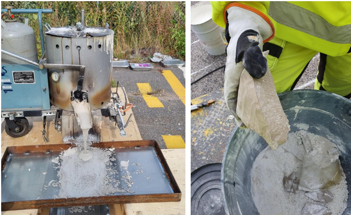
Figur 4 Omsmältning av rengjord termoplastisk vägmarkeringsmassa. Foto: Svevia.
